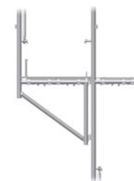
Detalle de ménsula de acercamiento a fachada.
