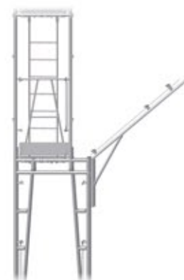
Andamio en fachada con visera de protección y paso peatonal.
